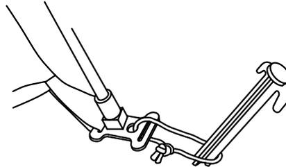
5. Sichern Sie die Muschel indem Sie die Heringe durch die Bodenschlaufen an den 3 Gestänge-Enden in den Boden schieben.
