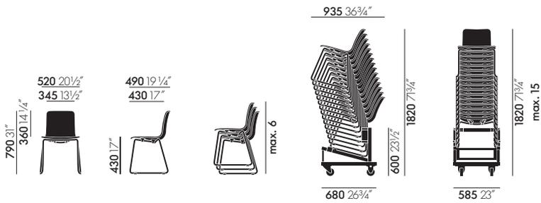
HAL Sledge, Schlitten-Stahlrohruntergestell, stapelbar
