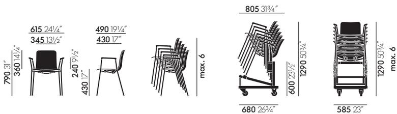
HAL Tube Armrest, Vierbein-Stahlrohr-Untergestell, stapelbar
