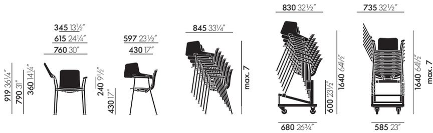
HAL Tube Writing Tablet, Stahlrohruntergestell, stapelbar
