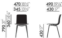
HAL Tube, Vierbein-Stahlrohruntergestell, nicht stapelbar
