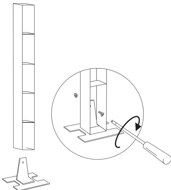
Um die Luft mit dem Fuss freistehend zu verwenden, die Luft von oben in den Fuss stellen.
