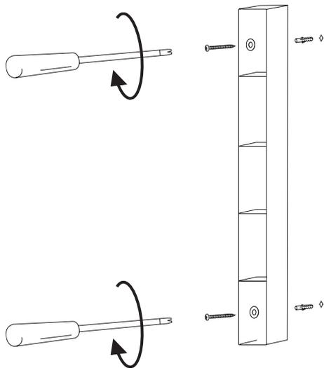
Für die Montage der Luft an der Wand am gewünschten Ort die beiden Löcher markieren. Verwenden Sie dazu die Luft als Schablone.
